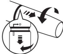
2. Установите две щелочные (щелочные) батареи типа AA таким образом, чтобы положительные (+) и отрицательные (-) контакты совпадали с полярностью, указанной в отсеке для элементов питания.
