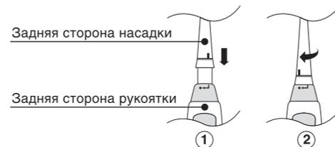
Фиксация насадки происходит в момент совмещения отметок «тире» на задней стороне насадки и «точка» на задней стороне рукоятки.
